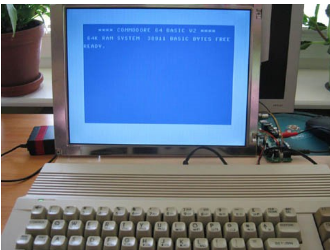
Bild 6: Commodore C64 über Composite Video verbunden. Qualität akzeptabel
